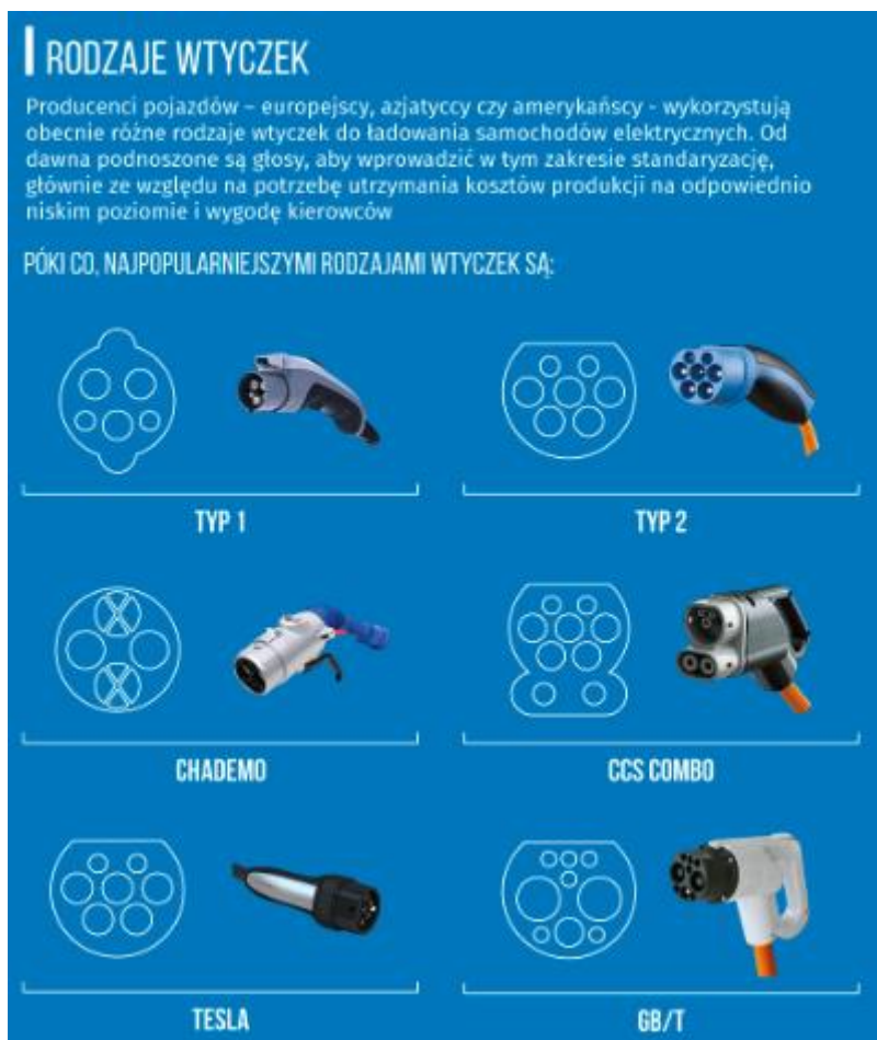
Rysunek 23. Rodzaje wtyczek do ładowania samochodów elektrycznych stosowanych na świecie Źródło: http://pspa.com.pl/infografika/abc-ladowania-pojazdow-elektrycznych
