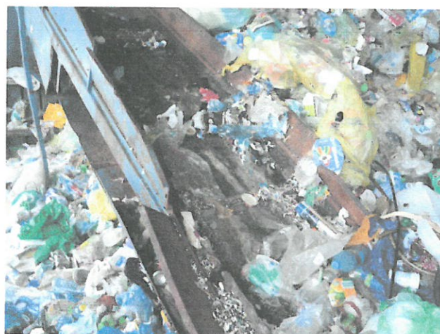
Fot. Nr 4 – uszkodzenia transportera;
