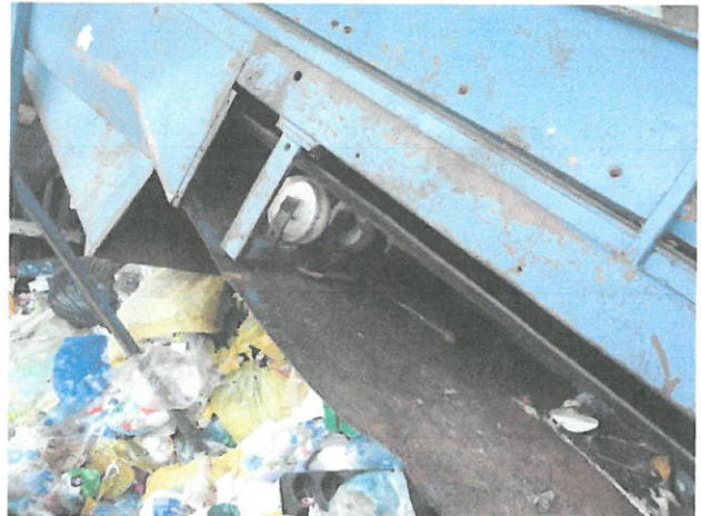
Fot. Nr 6 – uszkodzenia transportera;
